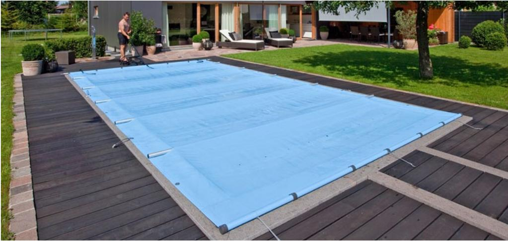
Freibadabdeckung ohne Wasserberührung für Skimmerbecken. Wirksam als Unfall- Schmutz- und Wärmeschutz. Bestehend aus polyesterarmerter, haltbarer STAMOID- Folie, getragen durch quer eingearbeitete Alu-Rohre im Abstand von ca. 1,30 m. Mittig eingestanzte Regenabläufe. Oberfläche glatt und pflegeleicht. Bedienung mit Handkurbel 1:3 (bis 46 m²) bzw. 1:7 (über 46 m²). Geeignet für Becken bis 5 m Breite. Inkl. Abspanngurte mit Schnellverschluss und versenkbaren Edelstahlstiften.
