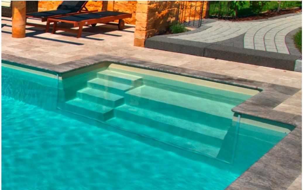
Zum Einbau in STYROPOOL®-Becken oder mit Folie ausgekleidete Betonbecken, aus glasfaser-verstärktem Polyester mit profilierten Trittstufen, Treppenstützen und Klemmflansche zum Verflanschen der Innenhülle oder Folie. Treppen entsprechen der Norm DIN EN 16582-1.
