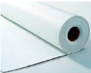
Verrottungsfestes Polyestervlies zur Wärmedämmung und zum Schutze der Innenhülle, in Ballen zu 18, 25, 50, 75 und 100 m<sup>2</sup> lieferbar. Besonders schwere Qualität, ca. 350 g/m<sup>2</sup>, Breite: 200 cm bzw. 150 cm bei 75 m<sup>2</sup>-Ballen.
